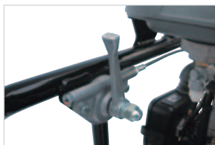
Leva acceleratore originale Mikasa in alluminio pressofuso
