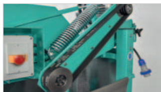
Trasmissione con tre cinghie trapezoidali dentate e pulegge calettate.
