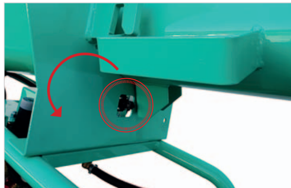
Sensore di sicurezza apertura camera di miscelazione
