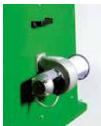
Sul retro della macchina è installato un efficace ventilatore che provvede a raffreddare l'impianto elettrico, i due inverter e i due motori, per operazioni 24 ore su 24.
