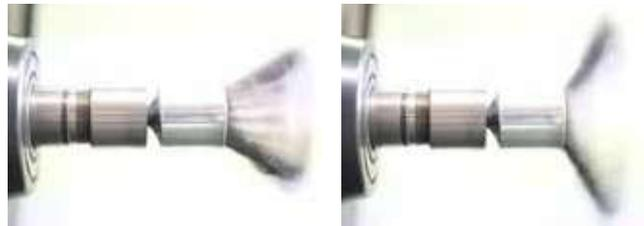
Le spazzole SIT sono sottoposte a test di collaudo secondo la norma UNI EN 1083-2, che definisce i requisiti di sicurezza relativi alla costruzione delle spazzole.
