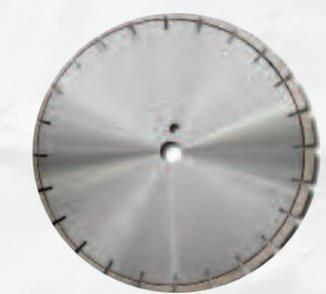
Disco diamantato universale, foro 22,2 mm. Idoneo al taglio di qualsiasi materiale (anche CLS armato). Saldatura laser.
