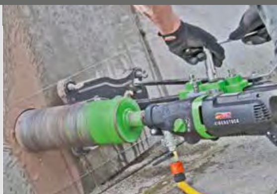
BST 182 V/S: carrello montato su 4 sfere speciali
