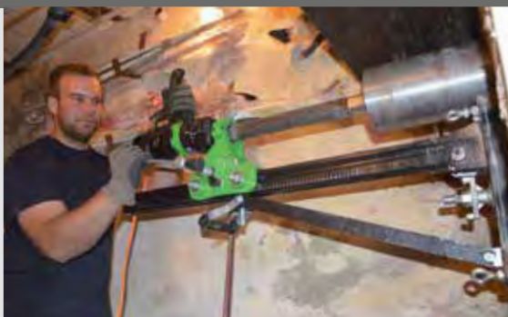
BST 182 V/S: carrello montato su 4 sfere speciali
