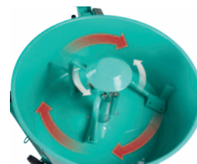
Sistema di inversione del senso di rotazione delle pale. Permette di disintegrare eventuali grumi e di riprendere la mescolazione normale senza interventi manuali diretti.
