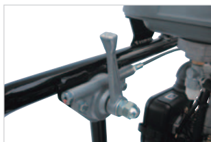
Leva acceleratore originale Mikasa in alluminio pressofuso
