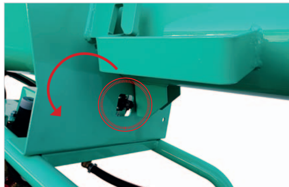
Sensore di sicurezza apertura camera di miscelazione
