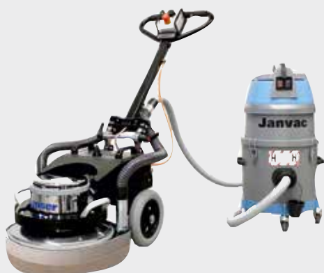
Nella foto si vede la levigatrice SPEEDTRONIC con sistema di aspirazione MULTI-VAC II e aspirapolvere JANVAC 1600-H
