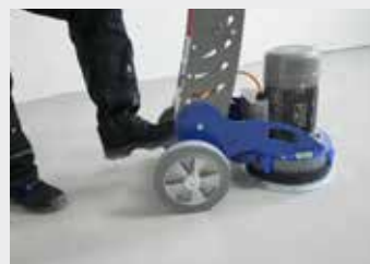
Con poggiapiedi per inclinare facilmente la macchina
