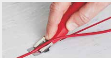
Taglio di sgrossatura con forcella distanziale in posizione di lavoro
